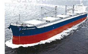
STAR PATHFINDER 約61,000トン、長さ約200メートル “初の外航船 ウルトラマックスバルクキャリア”
